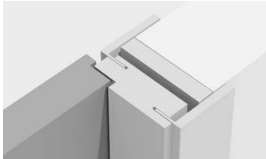
Sezione porta a battente con cerniere anuba
